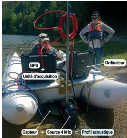
Photo 5 : à droite, acquisition en cours des données de sismique réflexion pendant la campagne de navigation de juin 2019 sur le lac d'Issarlès
