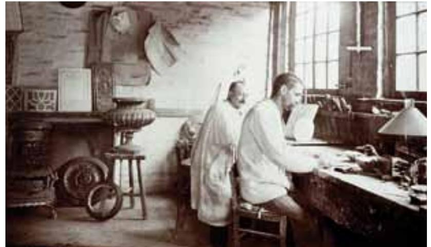
2. Les sculpteurs interprètent les dessins (accrochés au mur du fond) par des modèles en plâtre grande d'exécution. Le plâtre est teint à l'imitation de la fonte pour juger de l'effet produit par la pièce à la fin de la fabrication.
