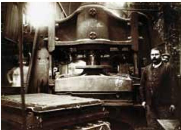
4-5. Les modèles en plâtre sont ensuite moulés pour fondre les formes de l'avant et du revers de chaque pièce. Ces plaques-modèles en métal servent à créer les empreintes en creux dans le sable des moules de fonderie qu'on passe à la presse.
